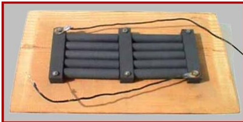
Illustration 1 : Exemple de microphone formé de deux groupes de cinq crayons de carbone. Les contacts aux extrémités étaient modifiés par les vibrations quand les ondes sonores faisaient bouger les crayons ce que permettait une variation plus importante du courant.
